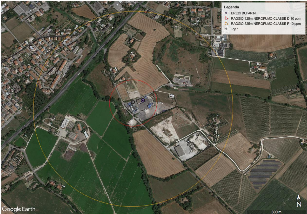
Figura 7: Aree di involuppo delle ricadute al suolo di Nerofumo da incendio del Top Event 1.
