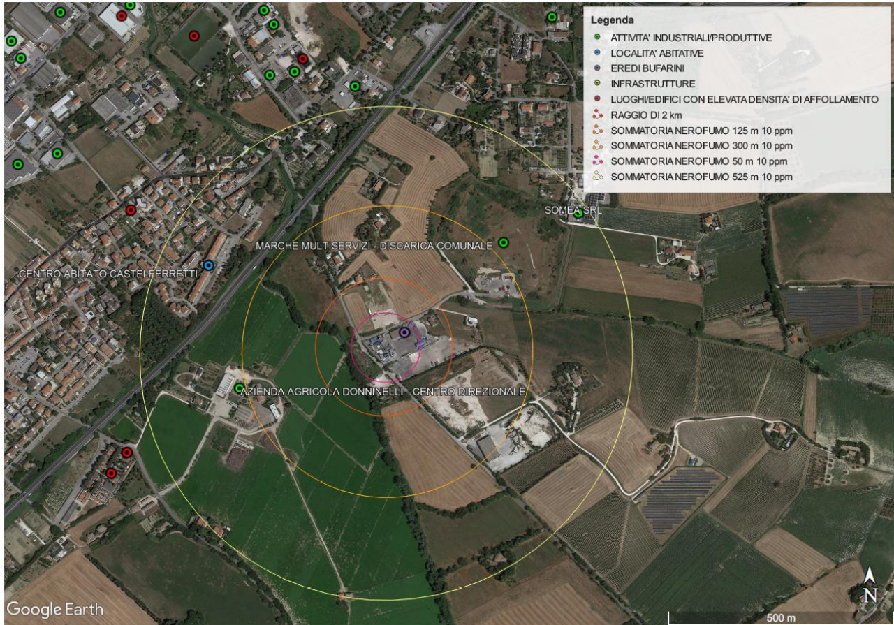
Figura 14: Sommatoria delle aree di inviluppo delle ricadute al suolo di Nerofumo di tutti i Top Event in correlazione ai punti ubicati all'interno delle stesse.
