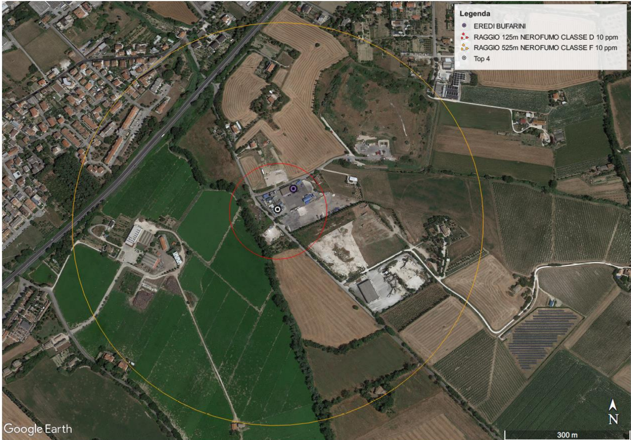
Figura 10: Aree di involuppo delle ricadute al suolo di Nerofumo da incendio del Top Event 4.
