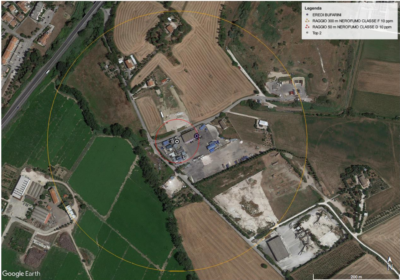
Figura 8: Aree di involuppo delle ricadute al suolo di NEROFUMO da incendio del Top Event 2.
